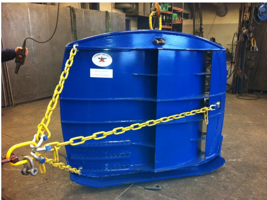
Figur 22: Tråldør for bruk til bunntålfisket.
