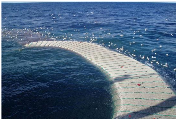
Figur 28: viser kolmulesekk med rundstroppler. røde bokser på sekken er fangstsensorer.
