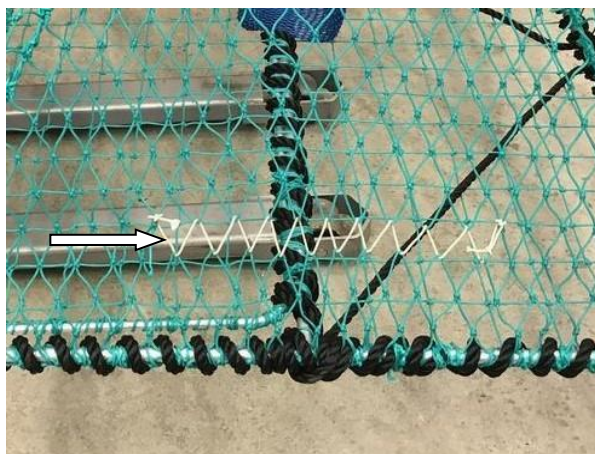
Figur 2. Sammenlisset rømmingshull i nedre del av kalven.
