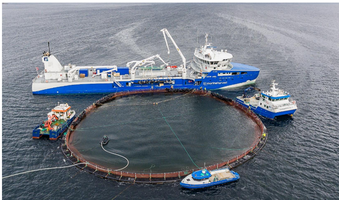
Figur 4 Avlusingsoperasjon med brønnbåt og servicefartøy
